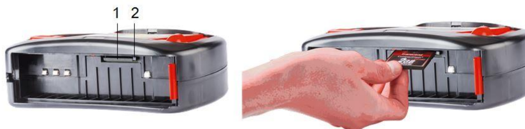
Rys. 7: Umieszczanie / wymiana SaveCard
